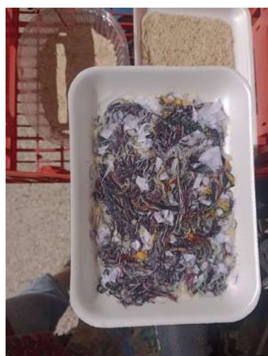
Fig 25. Prueba de la fórmula de tela triturada a base de aglutinante vegetal.
