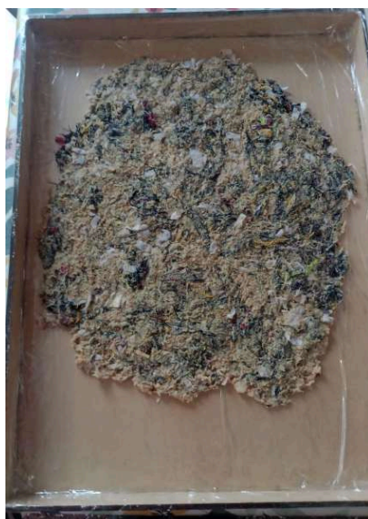
Fig 23. Prueba de la fórmula definitiva de aserrín, papel y tela triturada a base de aglutinante vegetal.
