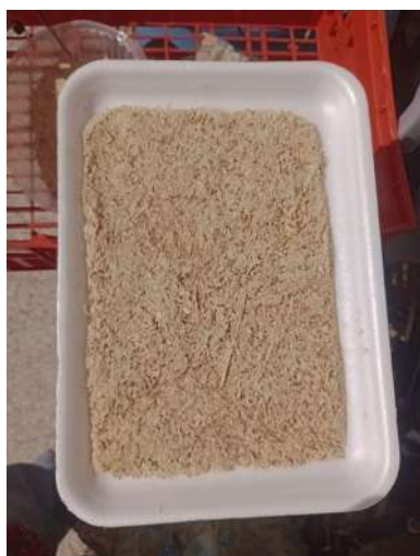
Fig 24. Prueba de la fórmula de aserrín a base de aglutinante vegetal.
