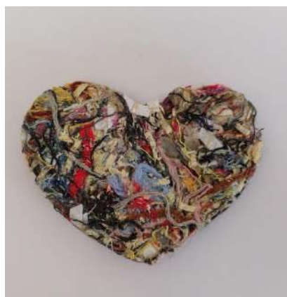
Fig. 51. Segundo prototipo de de tarjeta de biomaterial de tela y aserrín con aglutinante natural y semillas
