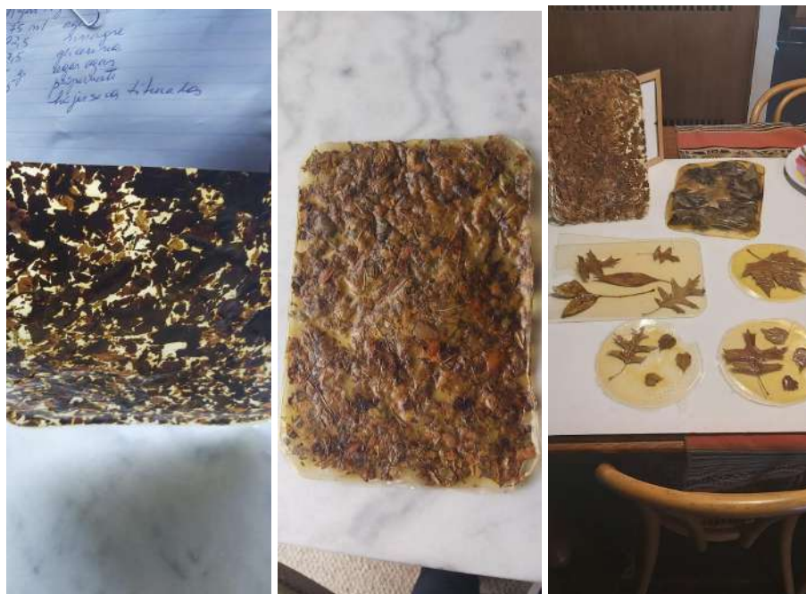
Fig. 22. pruebas de biomaterial de gelatina y hojas secas, estas pruebas se hicieron en busca de distintas texturas pero fueron desestimadas por ser quebradizas.
