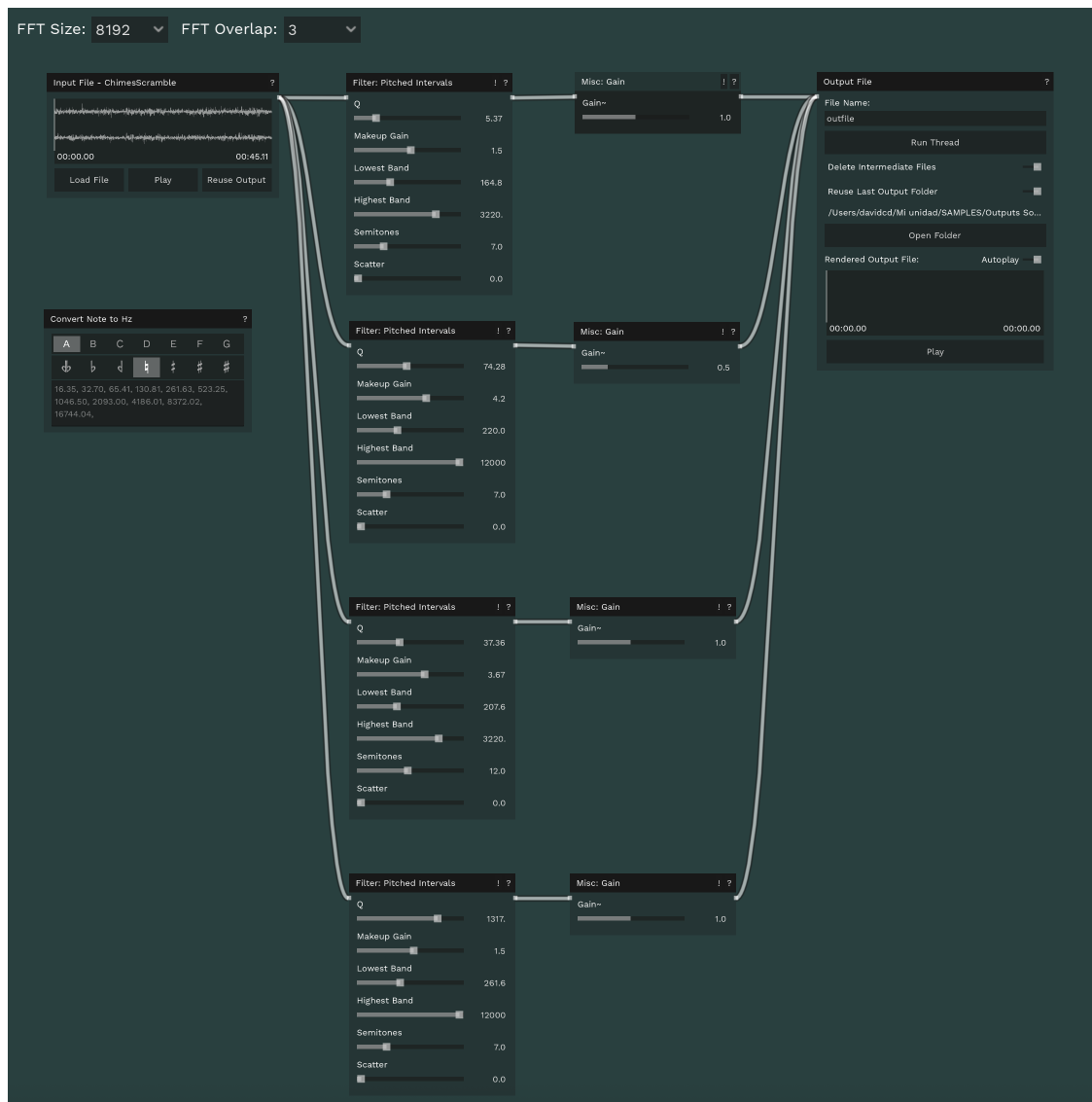
Figura 3. Segundo proceso: banco de filtros afinados con ganancias automatizadas
