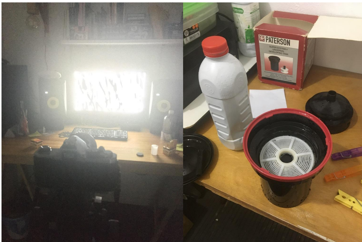
Proceso manual de blow out: cada rollo era procesado manualmente en un tanque Paterson con revelador y fijador
