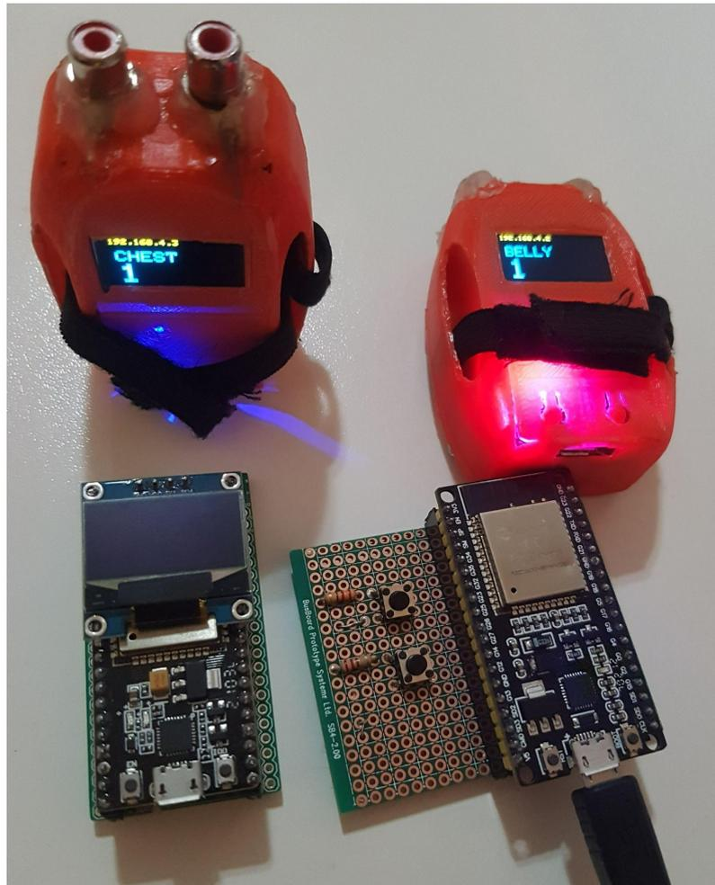
Fig. 28 versión 4 con ESP32. Server con botones para resetear los clientes, además de pantallas oled en los sensores CHEST y BELLY
