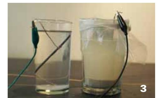
**1 Medición del voltaje de una CCM.**
