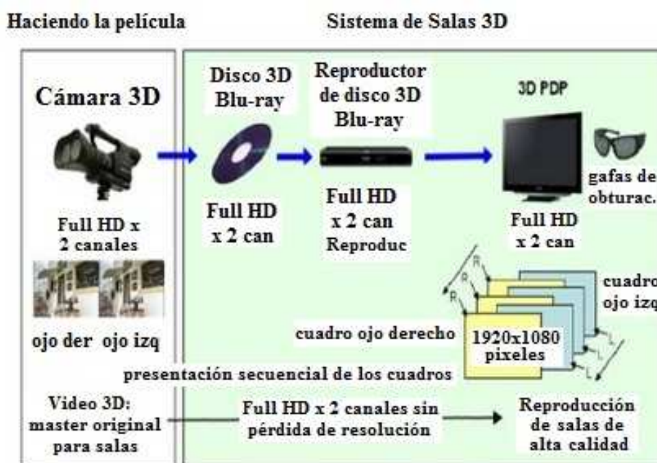
Fig.13: Masterización para cine digital 3d de alta definición.
