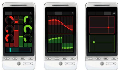
Figura 4. Se observa en los tres dispositivos ipod la aplicación denominada Apple TouchOSC por medio del cual se envían mensajes de control OSC vía WiFi .
